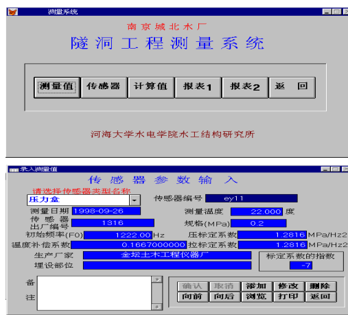
图3 隧洞工程监测信息数据库管理系统的人机界面
